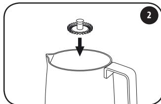
Inserire il disco dentellato nel perno sul fondo del bricco. Un disco dentellato di riserva è presente nell'alloggiamento posto sotto la base motore.
