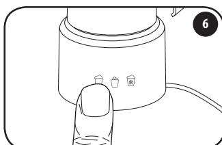
Démarrer le dispositif en appuyant sur le bouton de la préparation souhaitée. Le processus de préparation s'arrête automatiquement et l'appareil s'éteint.
