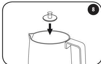
Inserire il disco liscio per mescolare nel perno sul fondo del bricco. Il disco liscio si trova nell'alloggiamento posto sotto la base motore.
