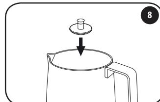
Introduire le disque dentelé à mélanger sur l'axe au fond de la carafe. Le disque lisse se trouve dans le compartiment sous la base du moteur.
