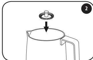
Introduire le disque dentelé sur l'axe au fond de la carafe. On retrouve un disque dentelé de recharge dans le compartiment sous la base du moteur.
