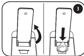
3 Sollevare la leva e inserire la cialda E.S.E. illy nell'apposita fessura con il logo rivolto verso la leva. Accertarsi che l'intera cialda, ad eccezione della linguetta, sia inserita all'interno della fessura.
