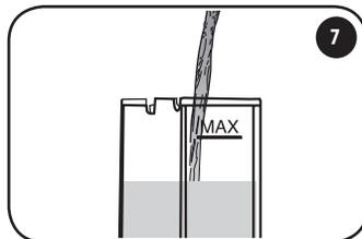
Rimuovere il serbatoio, sciacquarlo e riempirlo con acqua fresca. Reinserire il serbatoio con acqua fresca nella macchina.
