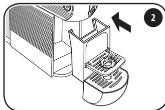
Svuotare il cassetto, lavare e asciugare i componenti prima di reinserirli nei propri alloggiamenti.
