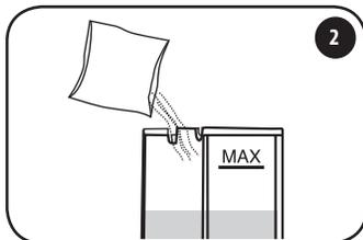
Riempire il serbatoio con 0,6 lt di acqua fresca ed aggiungere la soluzione decalcificante. Assicurarsi di sciogliere completamente la soluzione decalcificante all'interno dell'acqua nel serbatoio.
