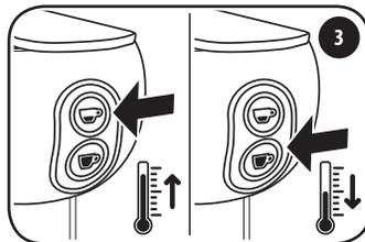
Premere il tasto ☕ per aumentare la temperatura di 3 gradi. Premere il tasto ☕ per diminuire la temperatura di 3 gradi.
