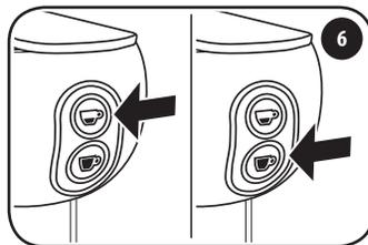
6 Per l'erogazione di un caffè espresso premere il tasto ☕. Per l'erogazione di un caffè lungo premere il tasto ☕. In caso di difficoltà di chiusura, riaprire la leva e richiudere.
