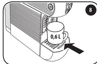
Posizionare un contenitore di almeno 0,6 lt sotto l'erogatore.
