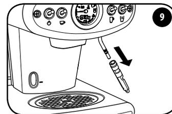
Démontez la partie intérieure de la lance à vapeur/eau chaude sur le tube métallique.
