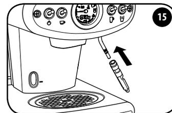
Monter la partie intérieure de la lance à vapeur/eau chaude sur le tube métallique.
