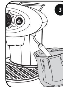
Einen geeigneten leeren Behälter (vorzugsweise aus Metall) unter die Dampfplanze stellen und die Taste drücken, um das restliche Wasser abzulassen; wenn nur Dampf herauskommt, neuerlich die Taste drücken.
