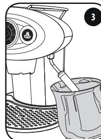
Inserire un contenitore idoneo (preferibilmente metallico) vuoto sotto alla lancia di erogazione vapore e premere il pulsante per far uscire l'acqua residua; quando esce solo vapore premere nuovamente il pulsante.
