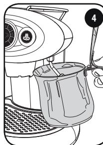
Immerger **entièrement** la lance à vapeur dans le lait. Appuyer sur le bouton et attendre la formation de la mousse. Une fois obtenu le résultat souhaité, appuyer à nouveau sur le bouton .
