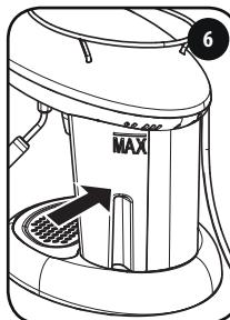
Insérer le réservoir dans la machine ; s'assurer qu'il soit entièrement inséré.
