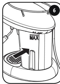
Τοποθετήστε τη δεξαμενή στη μηχανή, βεβαιωθείτε ότι έχει εισαχθεί πλήρως.
