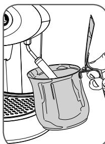
Τοποθετήστε ένα μεταλλικό δοχείο κάτω από το ακροφύσιο ατμού.
