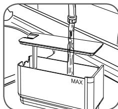
Den Tank "L" und Deckel herausnehmen und unter fließendem Wasser spülen.
