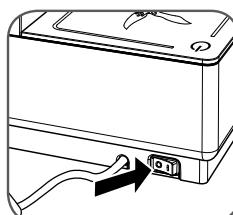
Desligue a máquina, colocando o interruptor geral "M" na posição "0".
