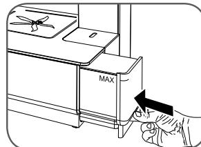
Depois de ter recolocado a tampa, insira completamente o reservatório na máquina, até ouvir um clique, a confirmar que ele está bem encaixado.
