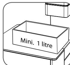
Vider le récipient et le replacer sous le groupe d'écoulement "C".
