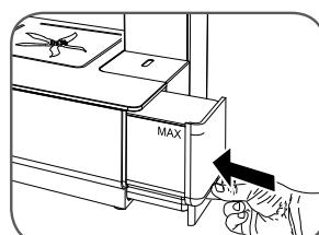
Après avoir replacé le couvercle, insérer complètement le réservoir dans la machine jusqu'au déclic final afin d'être sûr
