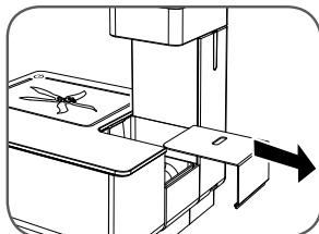
Para regular la altura del apoya-tazas "H", extraerlo tirando-hacia afuera y colocarlo en la posición taza alta o taza de espresso.
