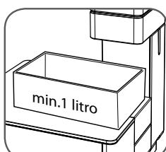
Sistemare un contenitore di almeno 1 litro di capacità sotto l'erogatore "C".
