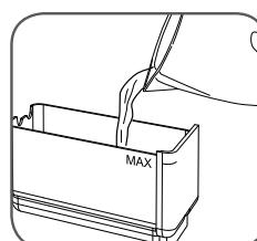
Retirer le réservoir d'eau «L» en vidant l'eau résiduelle avec décalcifiant
