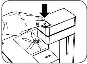
Baisser complètement la partie mobile de la tête de la machine et appuyer sur le levier "A" jusqu'à ce que l'on sente qu'elle est correctement fermée.
