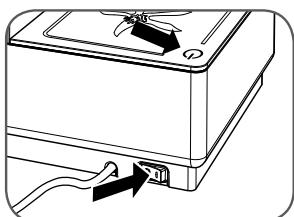
Coloque o interruptor geral “M” na posição “I”. Acende-se o indicador luminoso “D”.
