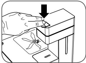
Cerrar la parte superior móvil de la cafetera, después presionar la palanca "A", hasta que se bloquee.
