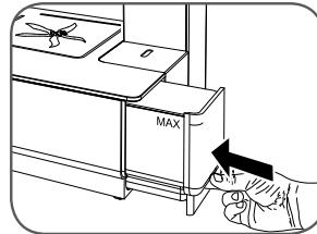
Nach Wiederaufsetzen des Deckels den Tank ganz in das Gerät einsetzen, bis er hörbar richtig eingerastet ist.
