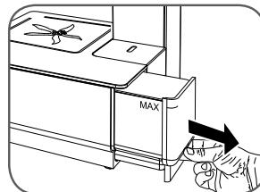
Retire o reservatório de água "L", puxando-o levemente para cima e depois para fora.
