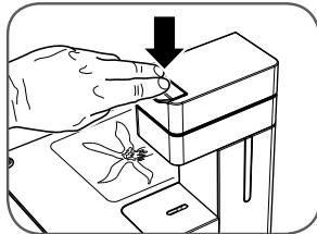
Abbassare completamente la parte mobile della testa della macchina, quindi agire premendo sulla leva "A" fino a quando si percepisce l'avvenuto blocco.
