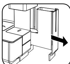
Extraer el contenedor de cápsulas usadas "G" tirándolo hacia afuera.
