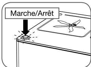
Appuyer sur l'interrupteur préparation café «F» uniquement si la lampe témoin est allumée. Le café commence à couler. Lorsque le volume souhaité est atteint, **interrompre l'écoulement en appuyant à nouveau sur l'interrupteur préparation café «F».**
