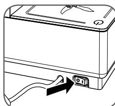
Éteindre la machine en mettant l'interrupteur général "M" sur "0".
