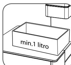
Vuotare il contenitore e riposizionarlo sotto l'erogatore "C".
