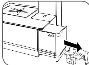
Verwijder het waterreservoir "L", door het iets omhoog te tillen en vervolgens naar u toe te trekken.
