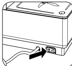
Disponer el interruptor general "M" en posición "0" para apagar la máquina.
