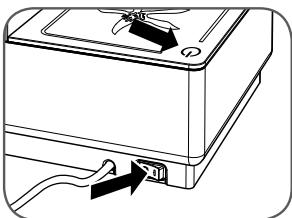
Mettre l'interrupteur général "M" sur la position "I". La lampe témoin "D" s'allume.
