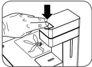
Abaixe totalmente a parte móvel da cabeça da máquina e, então, pressione a alavanca "A" até perceber que se bloqueou.
