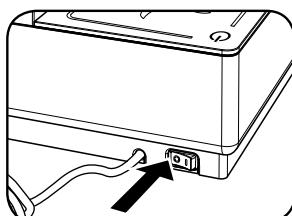
Controleer alvorens de stekker van de machine uit het stopcontact te verwijderen, of de AAN/ UIT schakelaar "M", in de AAN-stand "I" staat.
