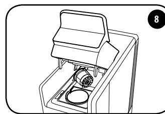
Para ejetar a cápsula utilizada, eleve lentamente a alavanca e a cápsula será coletada automaticamente no recipiente apropriado. Se a cápsula não for ejetada, repita a operação.
