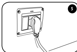
Die Maschine an die Steckdose anschließen.
