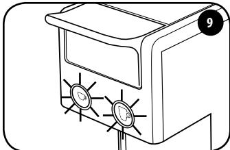
Wanneer de beide koffietoetsen onafgebroken oplichten, is de machine klaar voor gebruik.
