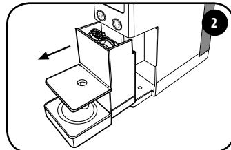
卸下咖啡胶囊回收托盘。咖啡胶囊回收托盘最多可容纳 7 个咖啡胶囊，因此建议定期将其清空以防止咖啡胶囊卡住。
