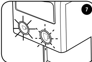
Nach Beendigung des Entkalkungszyklus leuchtet die Taste dauerhaft auf, während die Taste blinkt.
