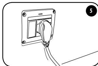
Sluit het apparaat aan op het stopcontact.
