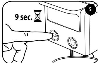
Tænd for maskinen ved at trykke på tasten i 9 sekunder.
