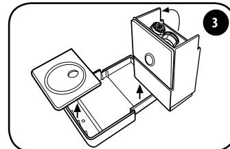
清空咖啡胶囊回收托盘并冲洗。清洁残余水和咖啡收集盘和格栅。清洁后，将收集盘与格栅重新钩接。
