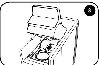
Um die leere Kapsel auszuwerfen, wird der Hebel langsam nach oben geschoben und die Kapsel automatisch in dem entsprechenden Behälter ausgeworfen. Wird die Kapsel nicht ausgeworfen, muss der Vorgang wiederholt werden.
