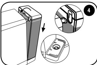
Sæt tanken i igen udfør de to åbninger og skub den mod maskinen indtil den fuldstændigt sidder fast.
