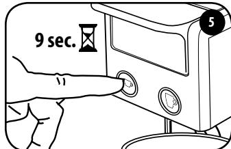
Zet het apparaat aan door de toets 9 seconden in te drukken.
