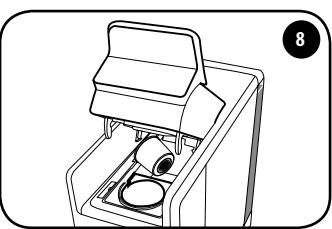
Для извлечения использованной капсулы медленно поднимите рычаг и капсула будет автоматически сброшена в специальный контейнер. Если капсула не сбрасывается, повторите действие.
