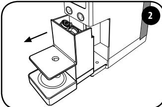
Den Auffangbeh ler f r leere Kapseln herausnehmen. Der Auffangbeh ler f r leere Kapseln fasst maximal 7 Kapseln, d.h. er sollte regelm ig entleert werden, um zu vermeiden, dass die Kapseln verklemmen.
