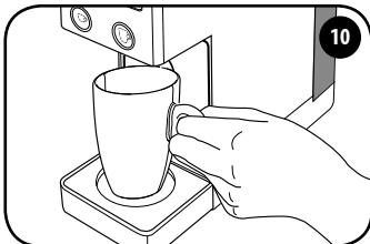
عندما يضيء كل مفتاحي القهوة بشكل ثابت، ضع فنجاناً كبيراً فارغاً تحت نقطة الصب. تكون الماكينة جاهزة للاستخدام.
