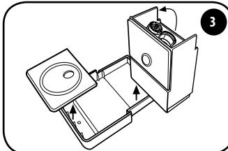
Den Auffangbeh ler f r leere Kapseln leeren und aussp len. Reinigen Sie die Tropfschale und das Gitter, um das abgetropfte Wasser und Kaffeer ckst nde zu beseitigen. Nach der Reinigung den Beh ler wieder in den Rost einsetzen.
