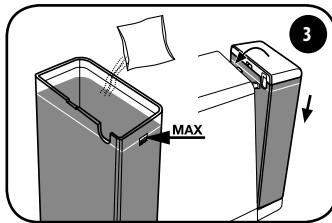
املاً الخزان بالماء العذب إلى الحد الأقصى وقم بإذابة محلول إزالة التربات. أعد إدخال الخزان وفقاً للشقيقين واصطحبه نحو الماكينة حتى يتم تثبيته بالكامل.
