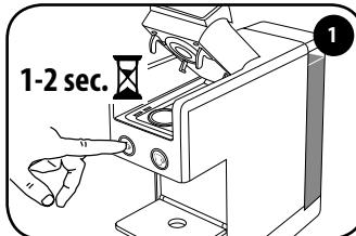
咖啡胶囊舱门打开时，通过按住两个咖啡冲泡按键之一 1-2 秒启动机器。
