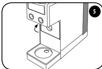
Mueva la rejilla de apoyo de la taza a la posición vertical. Llene el depósito solo con agua potable.
