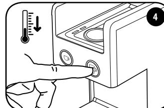
Die Taste drücken, um die Temperatur zu reduzieren. Die Taste blinkt. Nach ca. 3 Sekunden blinken beide Tasten.
