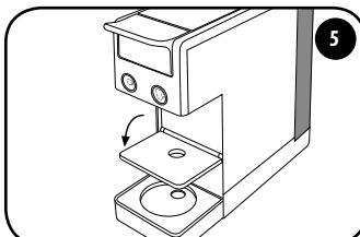
Den Tassenabstellrost absenken. Den Wassertank mit frischem Trinkwasser füllen.
