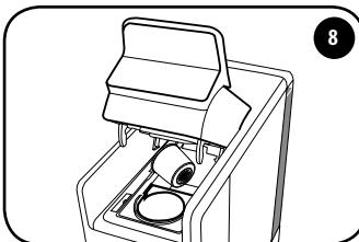
Til de hendel langzaam op om de gebruikte capsule uit te werpen. De capsule komt automatisch in de speciale verzamelbak terecht. Als de capsule niet wordt uitgeworpen, herhaalt de handeling.
