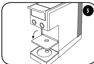
Abaissir la grille repose-tasses. Remplir le réservoir d'eau potable fraîche.
