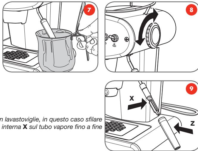
*Note: Le due componenti del terminale vapore si possono lavare anche in lavastoviglie, in questo caso sfilare anche la parte interna dal tubo metallico. Dopo la pulizia, inserire la parte interna **X** sul tubo vapore fino a fine corsa, successivamente inserire il tubo esterno **Z**.*
