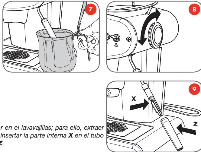
*Nota: Los dos componentes del terminal vapor también se pueden lavar en el lavavajillas; para ello, extraer también la parte interna del tubo metálico. Una vez efectuado el lavado, insertar la parte interna **X** en el tubo del vapor hasta final de carrera y a continuación montar el tubo externo **Z**.*
