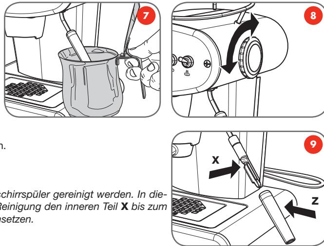
*Hinweis: Die beiden Komponenten der Dampfdüse können auch im Geschirrspüler gereinigt werden. In diesem Fall auch den inneren Teil aus dem Metallrohr abziehen. Nach der Reinigung den inneren Teil **X** bis zum Anschlag auf das Dampfrohr setzen, anschließend das äußere Rohr **Z** einsetzen.*
